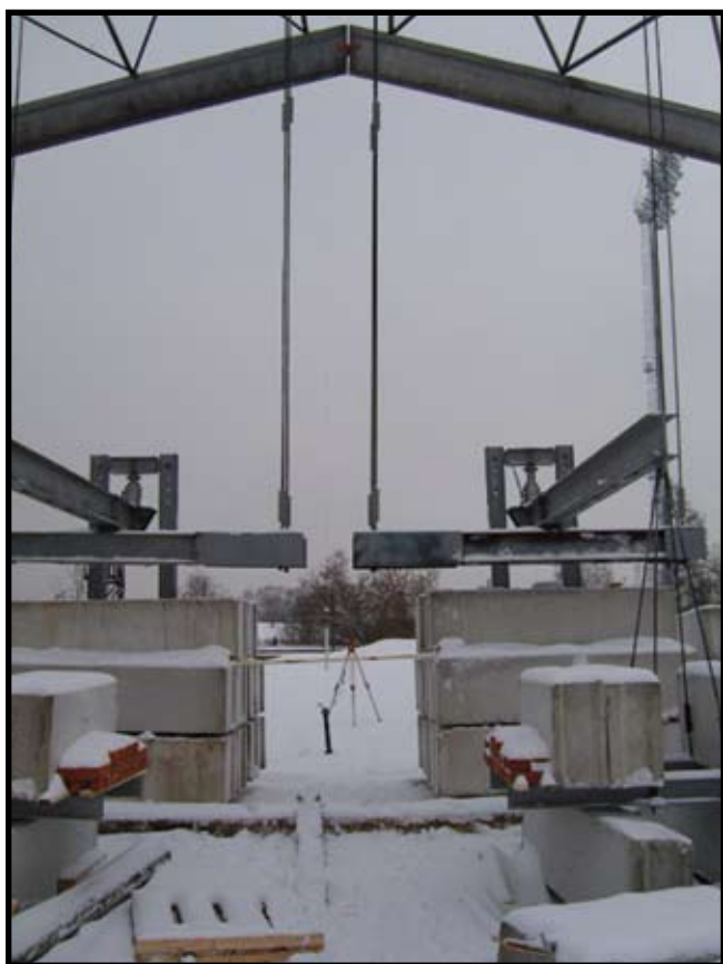
Фото 6. Оснастки и грузы для проведения испытаний, видны тяжи, закрепленные на ригели рамы, рычажная система, балластная загрузочная платформа
