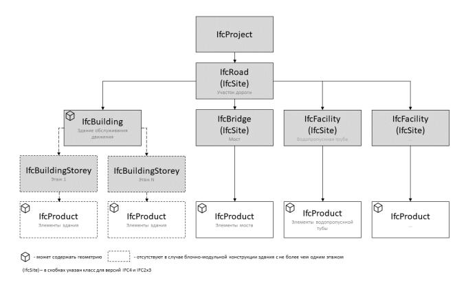
Рисунок 1.1 — Пространственная структура ЦИМ в формате IFC
