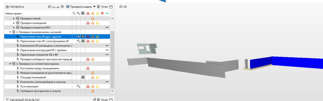
Автоматическая проверка пересечения конструкций
